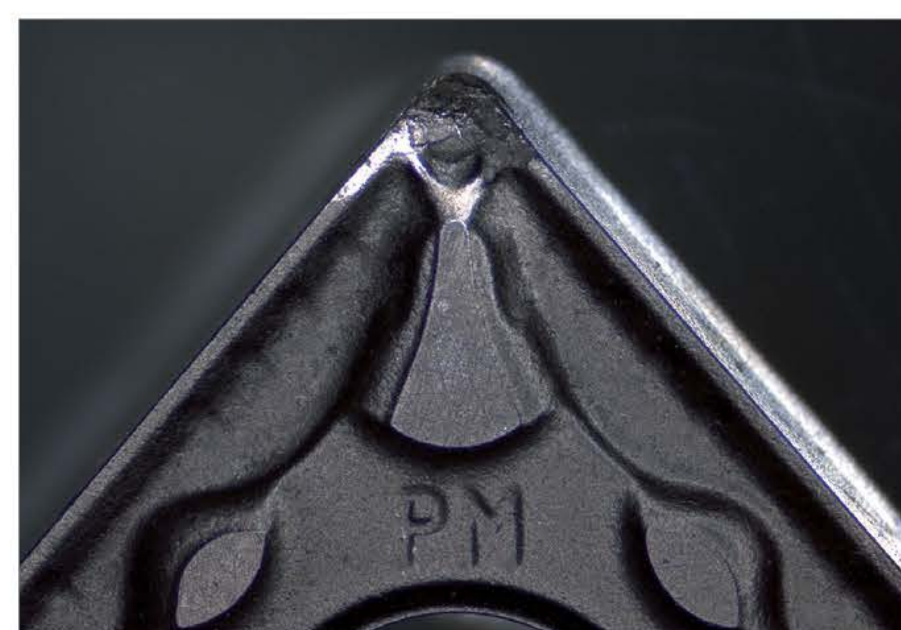
可轉位刀頭，顯示刀具磨損。 反射光，環形光，變焦 0.8x
